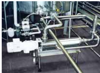
Насос seerex BCSB 10-12, продукт: кизельгур к фильтрации, давление: 3 бар, температура: 20-40°C производительность: 3 м³/ч
