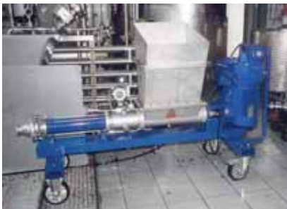
Насос seerex BTM 10-12 со съёмной воронкой из нержавеющей стали и мобильным приспособлением, продукт: вишни, давление: 12 бар, производительность: до 7 м 3 /ч
