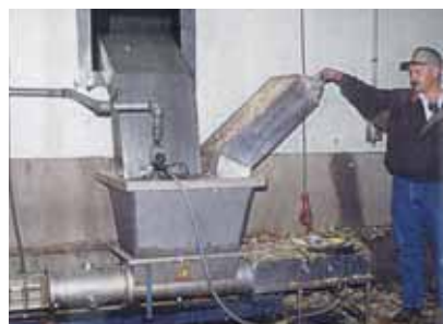
Насос seepex BTM 35-6, продукт: куры и отходы кур, вязкость: < 50.000 сП, давление: 3 бар, производительность: 5 м³/ч
