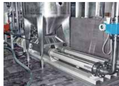
Насос seepex BT 35-24, продукт: морковная мезга из танка для дегазации к нагревателю, температура: 70°C, давление: 20 бар, производительность: 5-10 м³/ч
