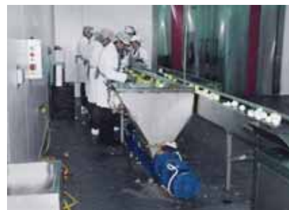
Насос seerex BTM 17-12 и контрольный транспортер
