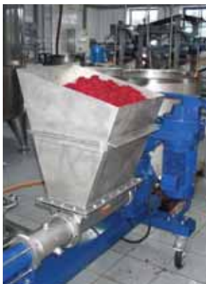
Насос seerex ВТМ 10-12, при размельчении и одновременной транспортировке смородины, производительность: 1-3 м 3 /ч
