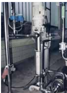
Насос seerex BCSO 17-12, продукт: сливки, пудинг и десертные продукты, температура: 25°C, давление: 6 бар, CIP-чистка: 3%-ый натриевый щелок и 2%-ая азотная кислота при 70-95°C около 1ч, производительность: 5-10 м 3 /ч
