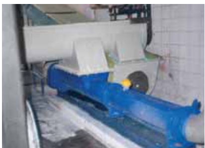
Насос seepex BT 70-6L, продукт: рыбный концентрат для транспортировки в сепаратор, температура: 90°C, давление: 2 бар, производительность: 12-22 м³/ч
