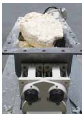
Насос seerex BTCI 10-12, для размельчения и перекачивания мягких сыров, вязкость: не текучие, температура: -от 1,3 до 2°C, давление: 7 бар, производительность: 2,3 м 3 /ч
